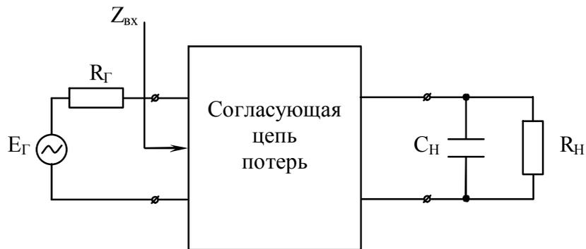
Рис. 2.35. Включение согласующей цепи без потерь
